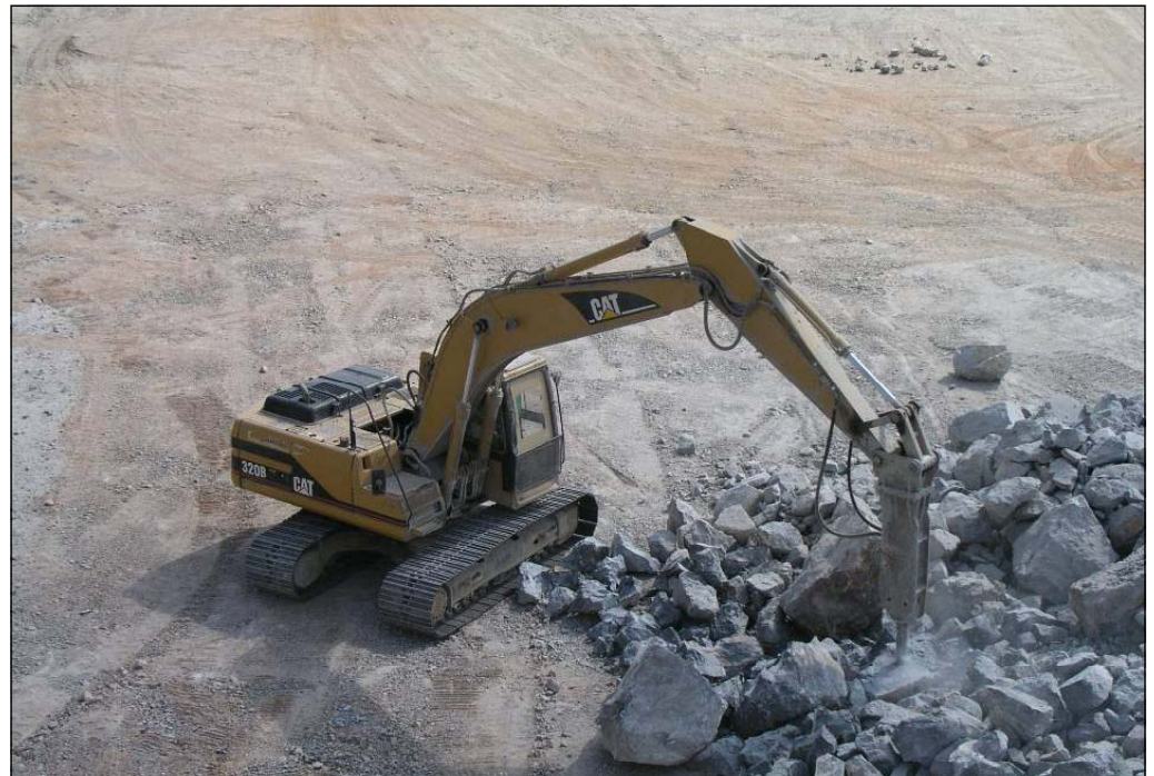
รถทุบหิน Hydraulic Breaker ลดการทำ Secondary Blast
