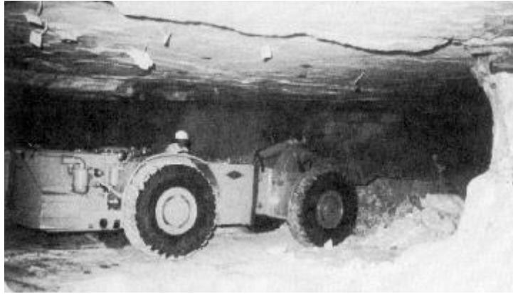
LHD (Load-Haul-Dump) ใช้ในการขนส่งแร่ในการทำเหมืองใต้ดิน
