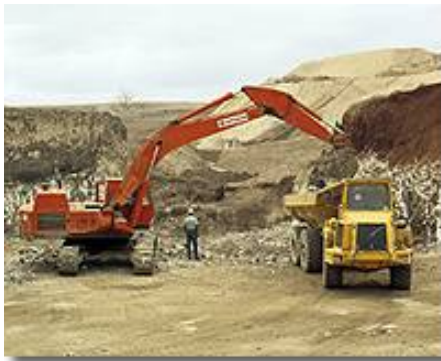
การขุดหน้าดินด้วยรถขุด back hoe กับรถบรรทุกและโดยการใช้ Bucket Wheel Excavator
