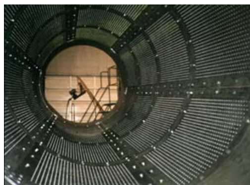
ภายในของตะแกรงหมุน (Trommels)
